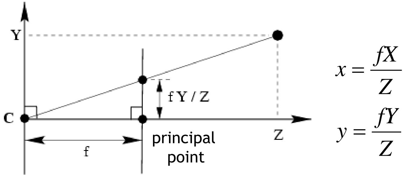
$$\begin{pmatrix} x \\ y \\ 1 \end{pmatrix} \sim \begin{pmatrix} fX \\ fY \\ Z \end{pmatrix} = \begin{bmatrix} f & 0 & 0 \\ 0 & f & 0 \\ 0 & 0 & 1 \end{bmatrix} \begin{pmatrix} X \\ Y \\ Z \end{pmatrix}$$
