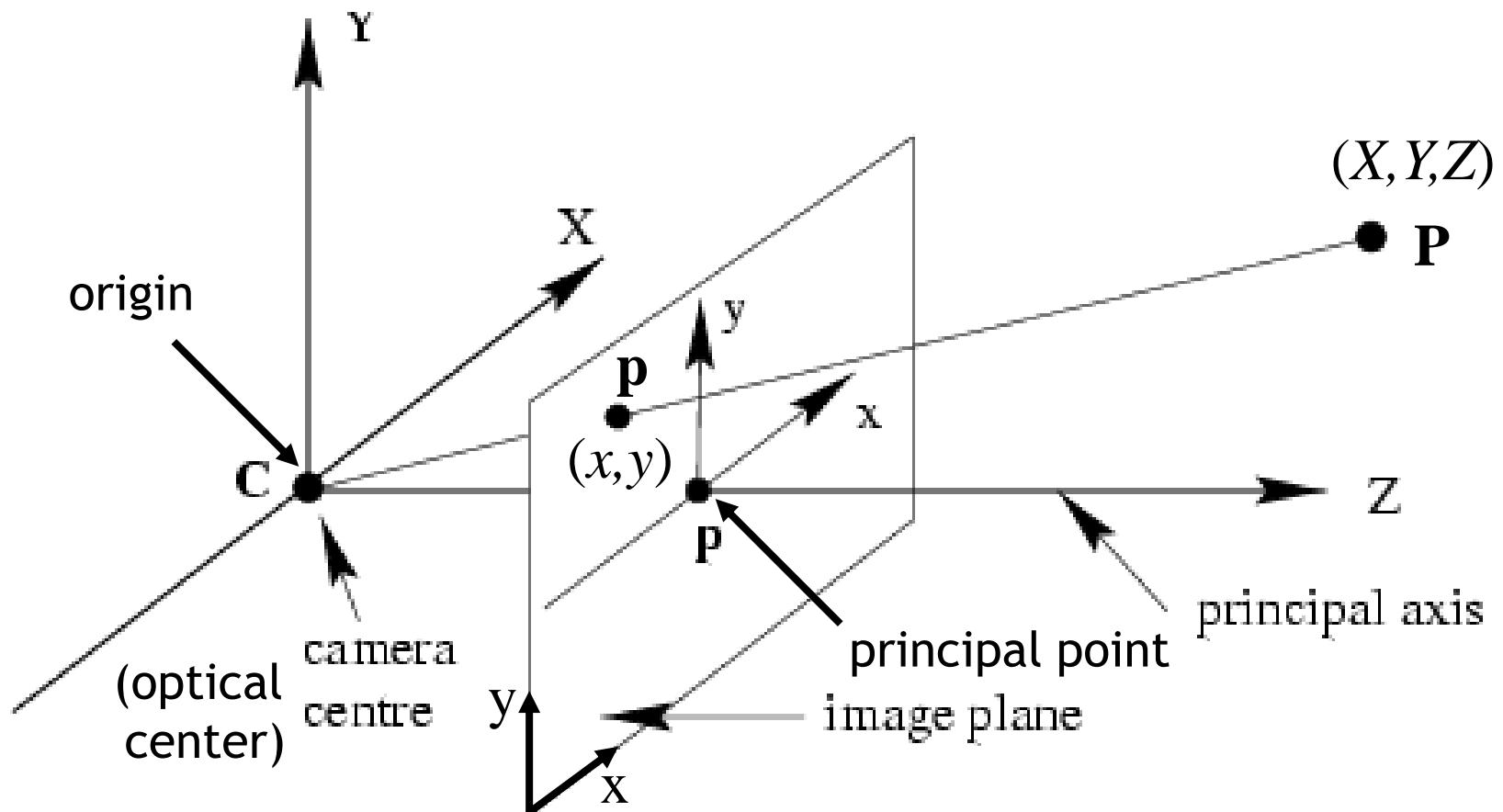
$$\begin{pmatrix} x \\ y \\ 1 \end{pmatrix} \sim \begin{pmatrix} fX \\ fY \\ Z \end{pmatrix} = \begin{bmatrix} f & 0 & x_0 \\ 0 & f & y_0 \\ 0 & 0 & 1 \end{bmatrix} \begin{pmatrix} X \\ Y \\ Z \end{pmatrix}$$
