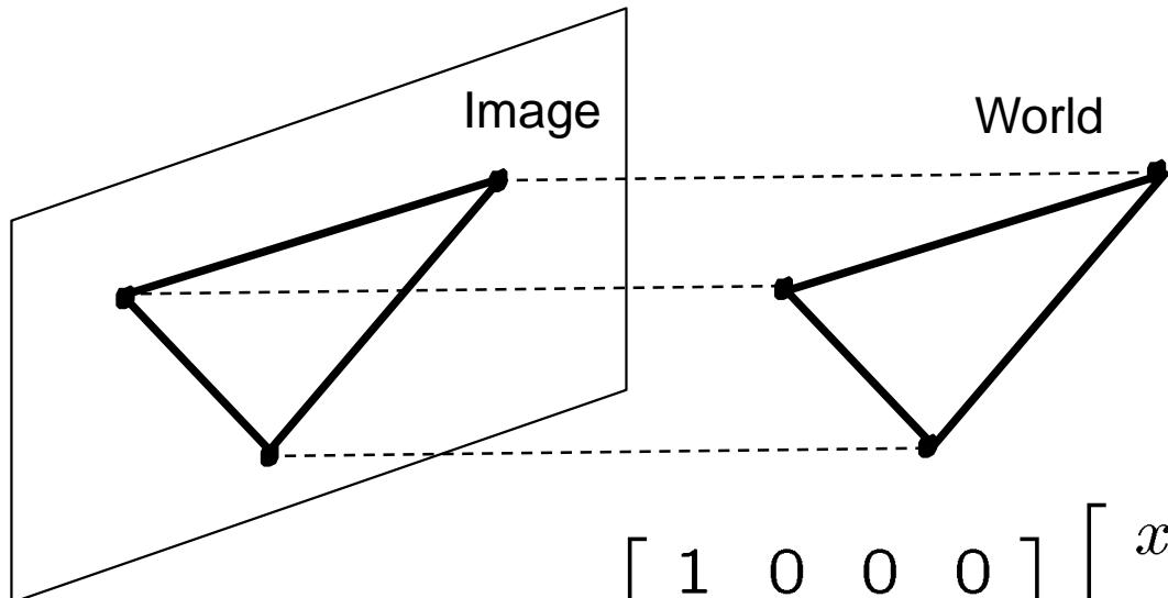
$$\begin{bmatrix} 1 & 0 & 0 & 0 \\ 0 & 1 & 0 & 0 \\ 0 & 0 & 0 & 1 \end{bmatrix} \begin{bmatrix} x \\ y \\ z \\ 1 \end{bmatrix} = \begin{bmatrix} x \\ y \\ 1 \end{bmatrix} \Rightarrow (x, y)$$
